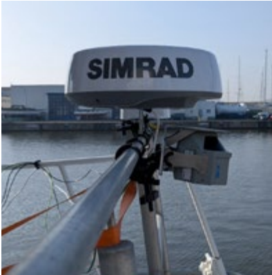
Für das Projekt nachinstallierte Sensorik (Radar und Lidar) zur Umfelderkennung auf der MS Geestemünde der Weserfähre GmbH.
