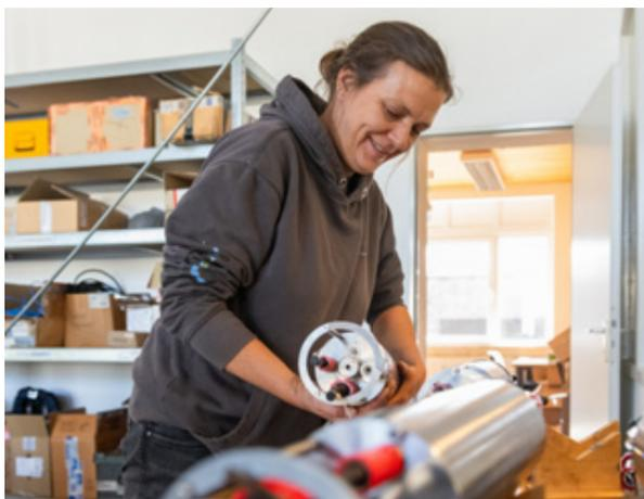
Dr. Antje von Glahn bereitet die Elektronikmodule vor, die später an die Lanze angeschlossen werden. Sie bilden das Herzstück der FIELAX-Messsysteme und müssen selbst unter hohem Druck zuverlässig funktionieren. | Foto: Foto: Aheads/Grochla
