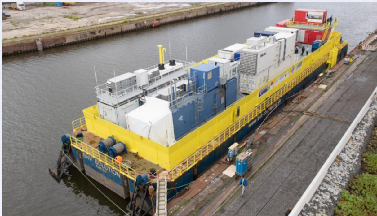
Die schwimmende H<sub>2</sub>Mare-Plattform produziert Wasserstoff direkt auf See. | Foto: BIS/Scheer
