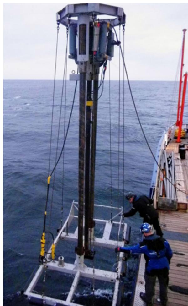
Das FIELAX-Messsystem geht in Kombination mit einem Vibrocorer der Firma Marine Sampling Holland zu Wasser. | Foto: FIELAX
