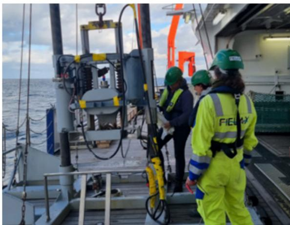
Das FIELAX-Messsystem in Kombination mit einem Vibrocorer der Firma Marine Sampling Holland wird für den Einsatz vorbereitet. | Foto: FIELAX
